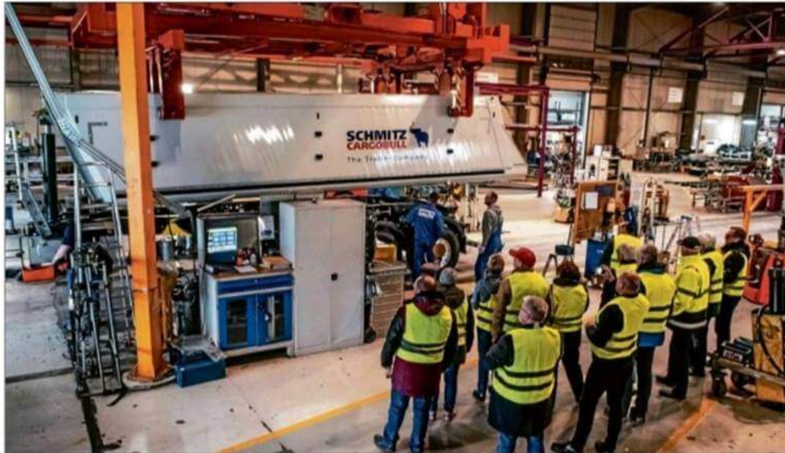
Aufmerksam verfolgen die Mitglieder des Gothaer Gewerbevereins die „Hochzeit“, die Verbindung der Kippmulde mit dem Fahrgestell in einer der großen Montagehallen bei Schmitz-Cargobull in der Kindleber Straße. 39 komplettierte Fahrzeuge verlassen zur Zeit täglich das Betriebsgelände. FOTO: PETER RIECKE
